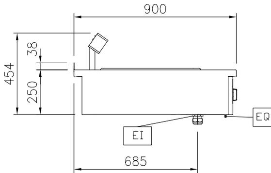
EI = Conexión eléctrica (energía)
